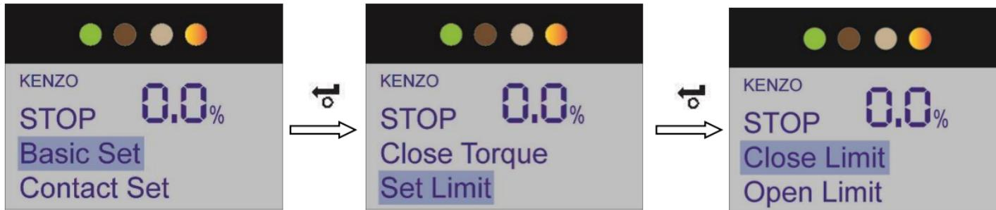
Примечание. От двигателя или вручную переведите клапан в полностью закрытое положение и не закрывайте клапан слишком тую чтобы не повредить клапан.
