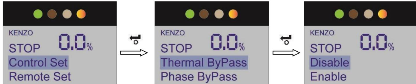
Примечание: температура тепловой защиты составляет 132 °С. Когда температура двигателя превысит 132 °С, сработает тепловая защита, отключит питание двигателя и остановит привод. Когда температура двигателя опустится ниже 132 °С, он сможет продолжить работу.
