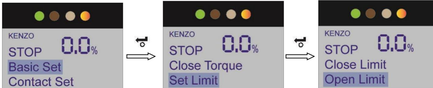
Примечание. Переведите клапан в полностью открытое положение электрически или вручную, и верните назад примерно на 1/2 - 1 оборот в направлении закрытия.
