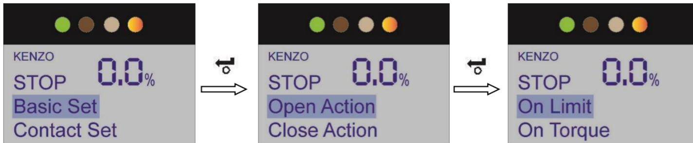
Примечание: когда установлен режим ограничения «по крутящему моменту», привод будет выводить значение крутящего момента, установленное в соответствии с крутящим моментом защиты направления открытия.
